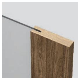
łączenie z szybą „na kant” skrzydło bezprzylgowe
