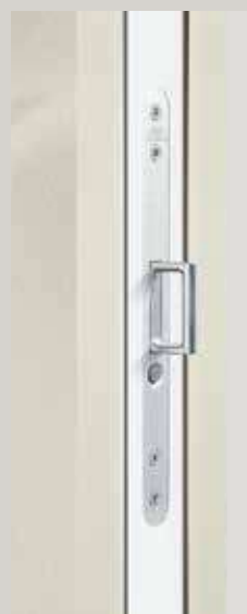
Uchwyt chowany pozwala na całkowite ukrycie drzwi przesuwnych w ścianie. Naciśnięcie przycisku umożliwia ponowne wysunięcie skrzydła drzwiowego i zamknięcie drzwi.
