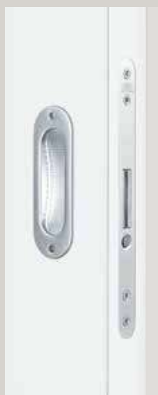
Uchwyt chowany pozwala na całkowite ukrycie drzwi przesuwnych w ścianie. Naciśnięcie przycisku umożliwia ponowne wysunięcie skrzydła drzwiowego i zamknięcie drzwi.
