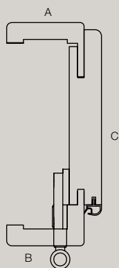
A: Opaska ozdobna B: Okładzina przyłgi C: Rdzeń ościeżnicy
